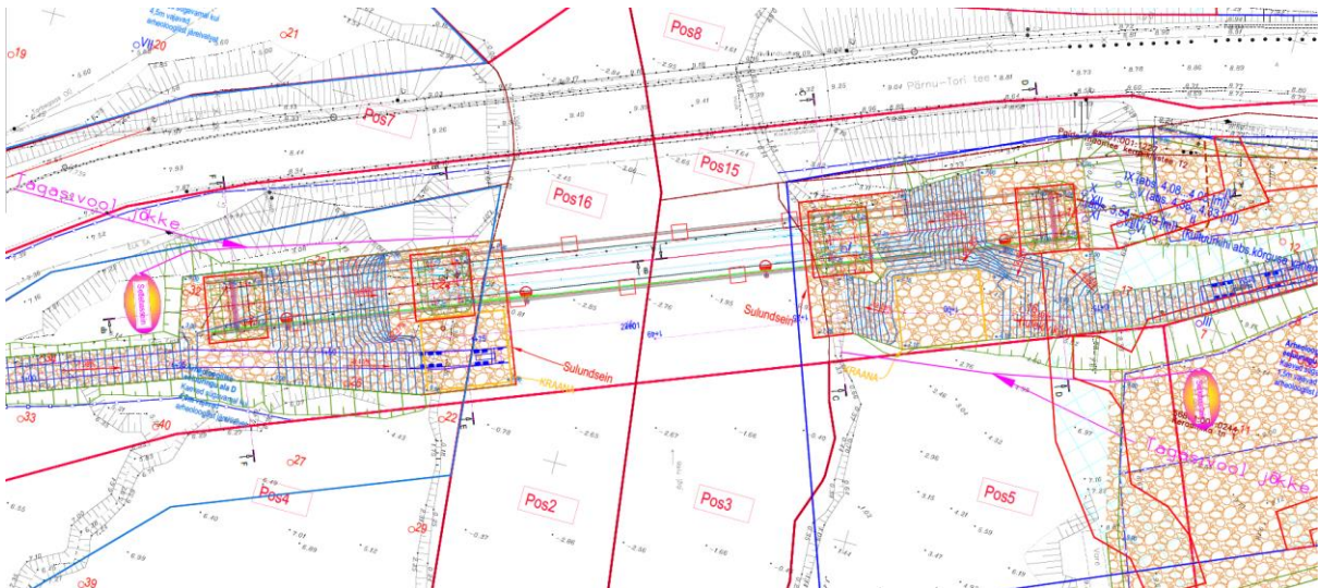
Joonis 1.4. Uue Sindi-Lodja silla ajutise ehitusaegse mulde, sh sulundseinte rajamine. Punakas-oranžikad ovaalid tähistavad ajutiste settebasseinide asukohta.
